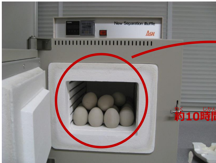
「タマゴ」を乾かして3日後に電気炉に入れる
